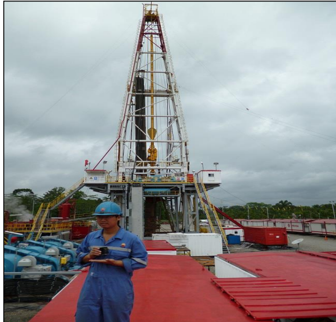
Figura 4.1 Sistema de levantamiento (Torre)
