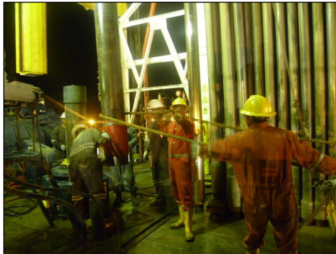
Figura 2.2 Mesa de Perforación (Conexión de tubería)
