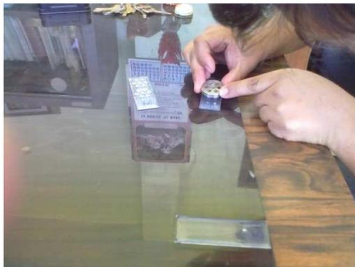
**FOTO 6** Se puede observar la presencia de la roseta que tiene 7 tubos de 5.3 mm la cual se uso para realizar las pocillas en las placas que se observa.
