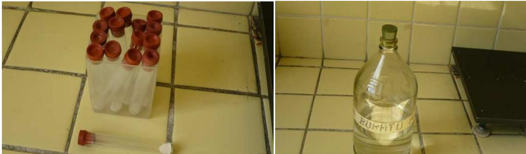
**FOTO 4** En la siguiente foto podemos observar a la izquierda agar noble 0.3 gr. En los tubos de ensayo y a su derecha ácido Bórico en un envase de 1000 ml los cuales deben conservarse a temperatura ambiente y lugar obscuro.
