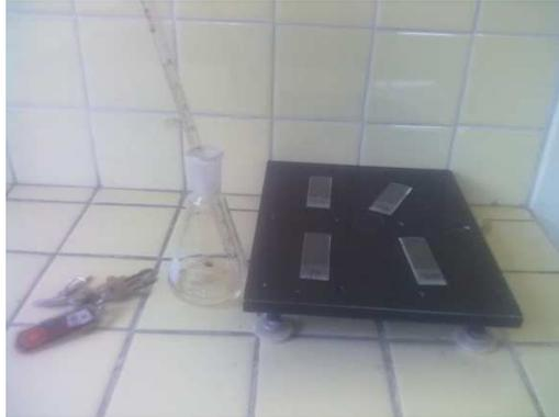
**FOTO 5** En la siguiente foto se puede observar las placas listas para ser usadas se puede observar en la misma la presencia de una probeta y una pipeta la cual contiene la mezcla del agar noble más el ácido Bórico en una concentración al 0.1%
