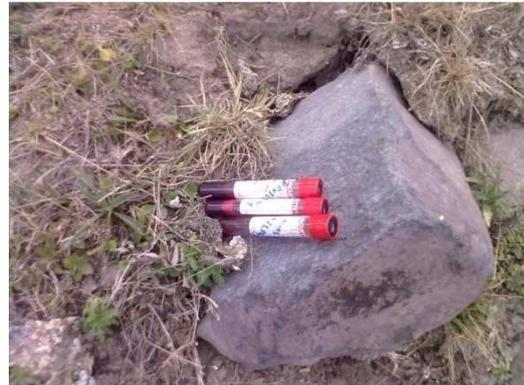
**FOTO 2** Identificación de los tubos de ensayo con su nombre del ejemplar, número de toma y su debido transporte para evitar el daño de muestra
