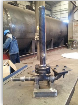
Figura 4.4. Fotos construcción bomba de ariete
