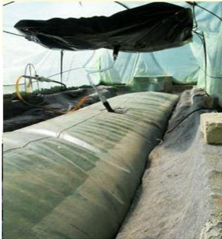
**Figura No. 3 Biodigestor tipo biobolsa**
