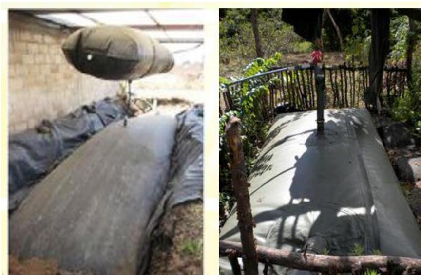
**Figura No. 1 Biodigestor de flujo continuo**
