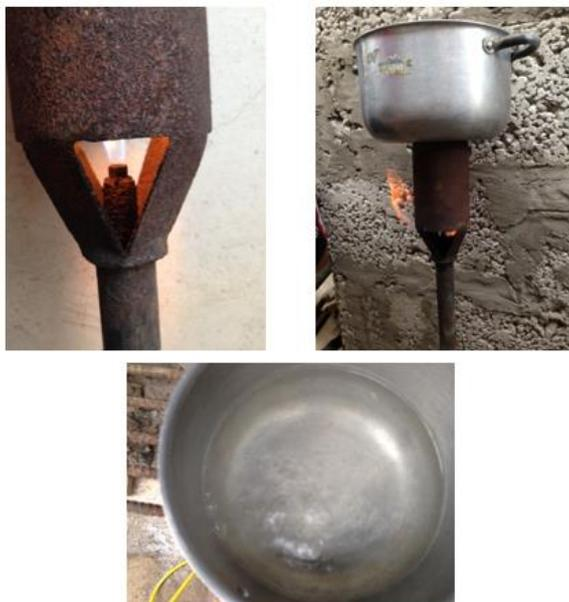
**Figura No. 11 prueba de combustión**
