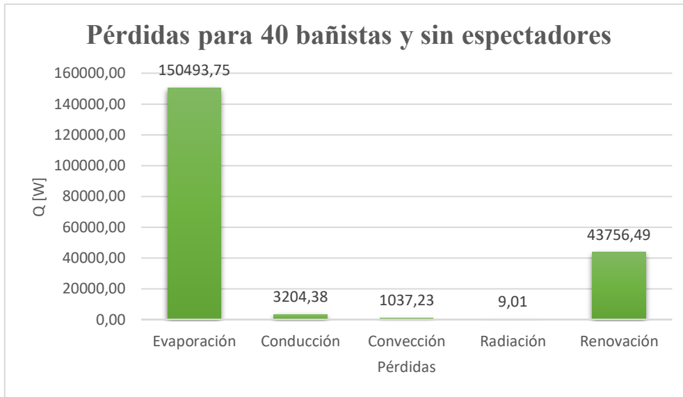
Figura 3.4 Pérdidas de calor de 9 am. a 9 pm
