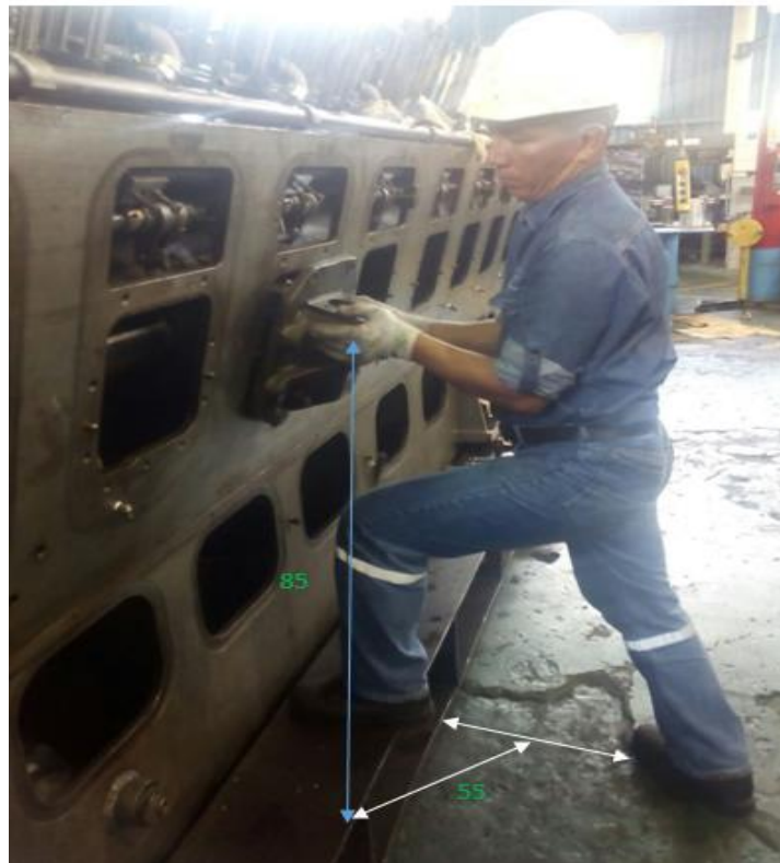
Figura 27: Medición de la distancia vertical y horizontal en el destino del montaje Elaborado por: Autor
