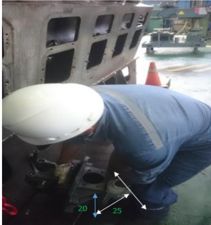
Figura 22: Medición de la distancia vertical y horizontal en el origen del montaje Elaborado por: Autor
