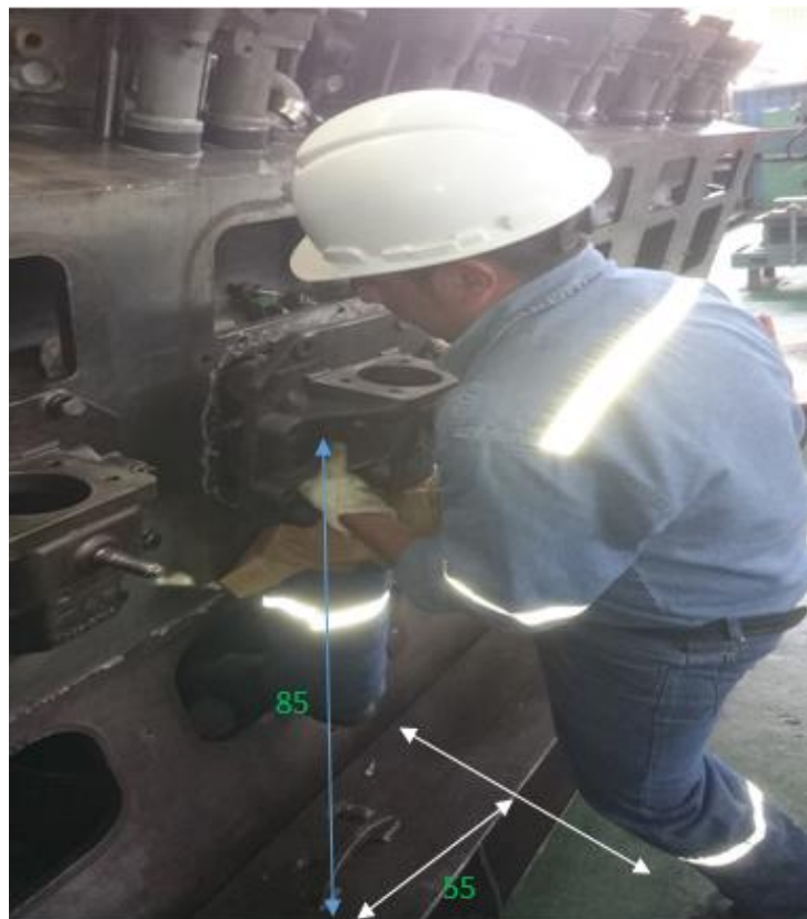
Figura 23: Medición de la distancia vertical y horizontal en el destino del montaje Elaborado por: Autor
