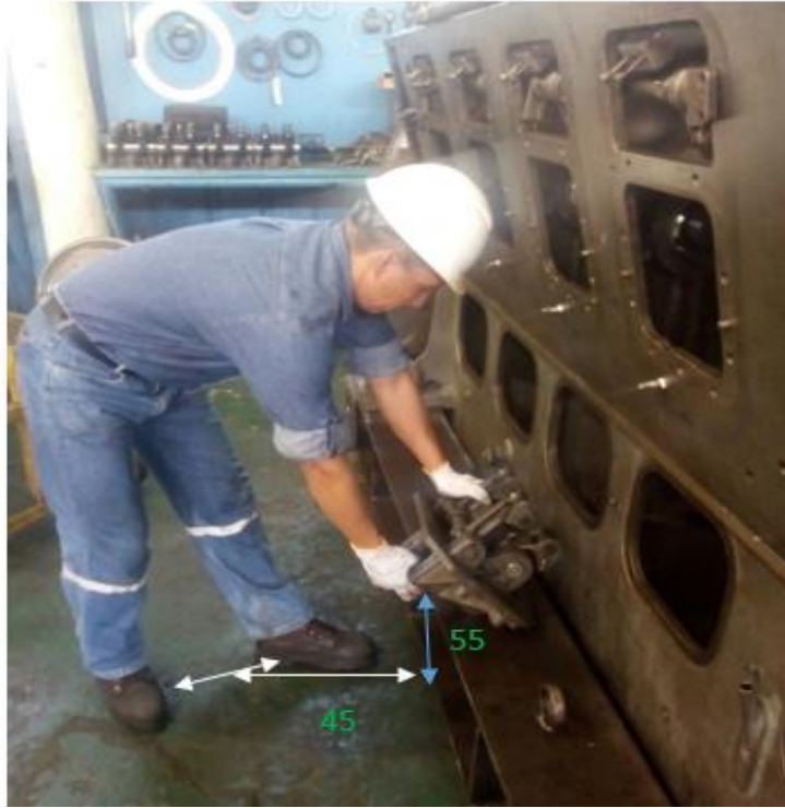
Figura 26: Medición de la distancia vertical y horizontal en el origen del montaje Elaborado por: Autor
