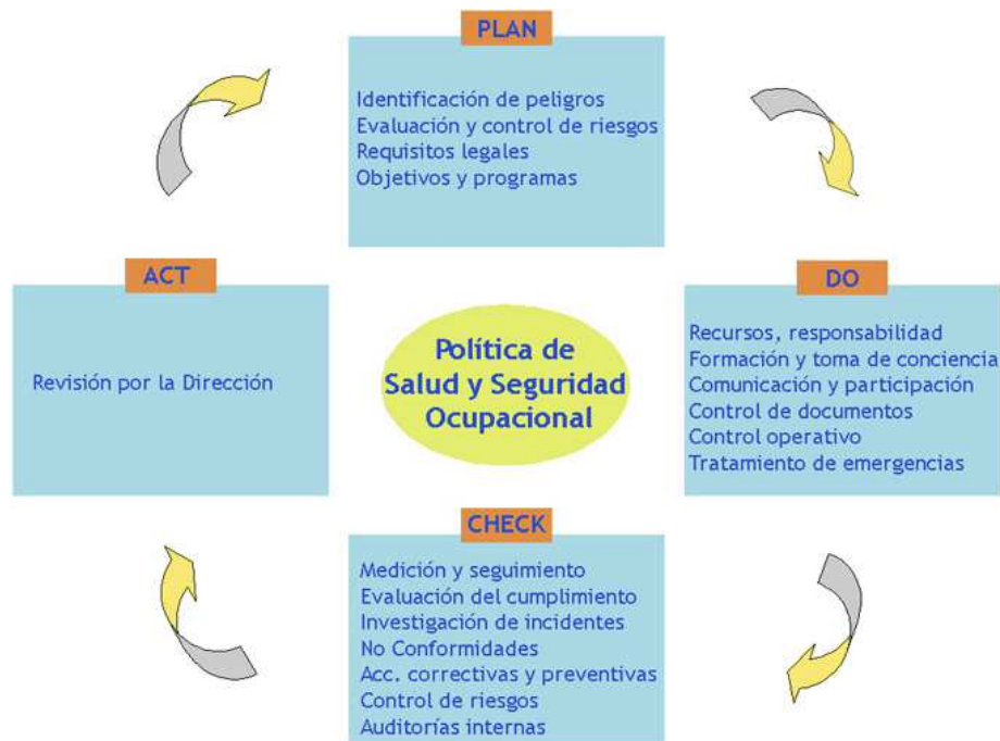
GRAFICO N° 11.- Ciclo de Deming aplicado a la seguridad y salud en el trabajo
