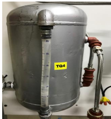
Figura 3.6. Tanque para control de caudal
