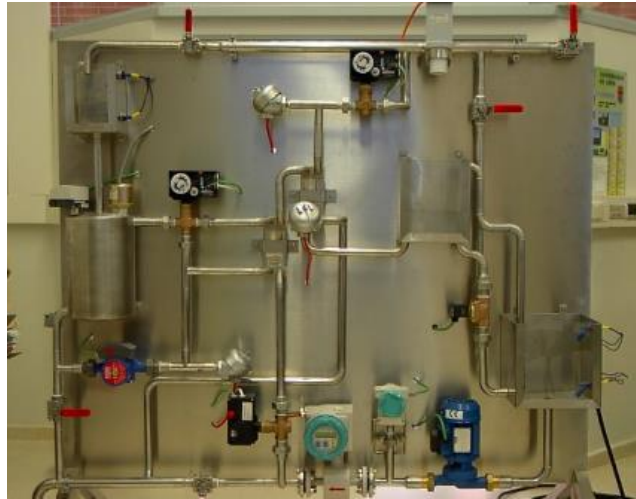
Figura 1.10. Prototipo de control de nivel, caudal, temperatura y presión de líquidos
