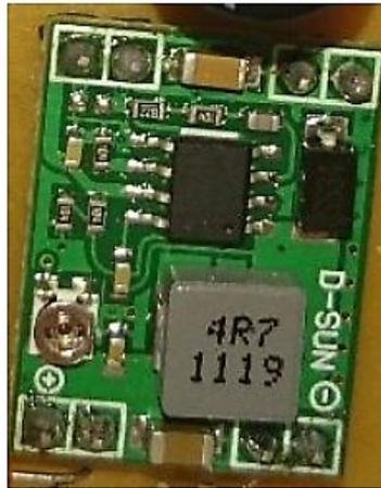
Figura 4—11: Convertidor DC a DC
