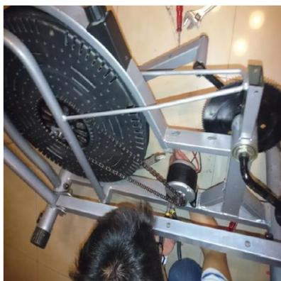
Figura 4—2: Sistema de transmisión cadena – piñón
