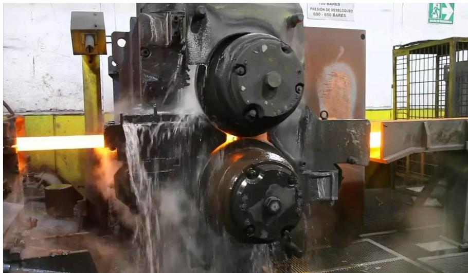
Figura N° 1. 1 Rodillos de desbaste laminación.
