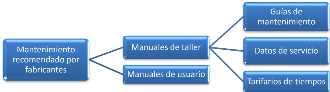
Figura 1.4. Mantenimiento recomendado por fabricantes
