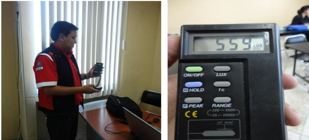
FIGURA N°41: LUXÓMETRO AEMC SERIE 810
