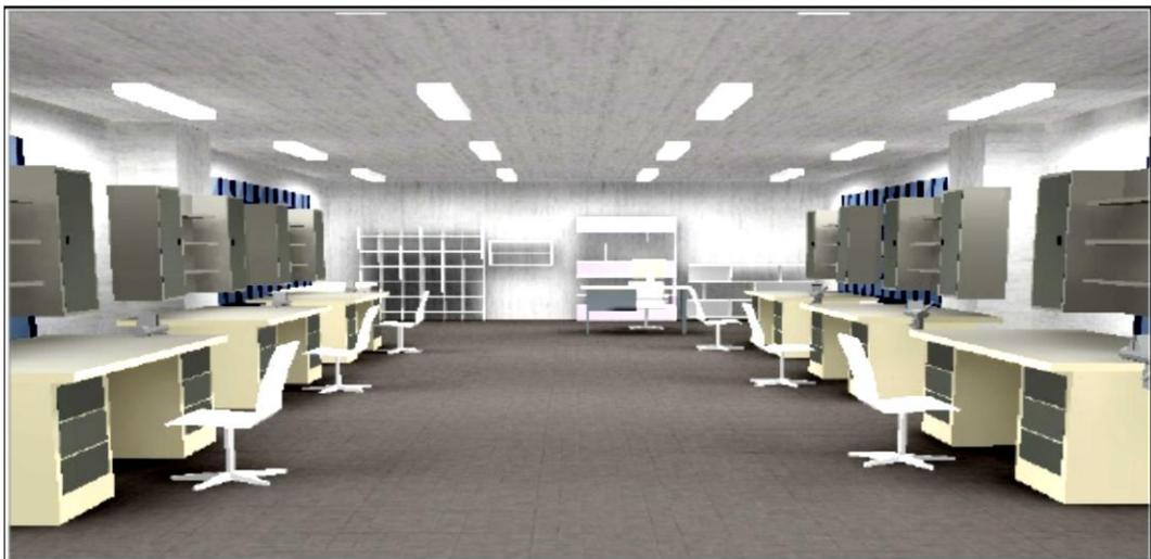
FIGURA N°40: SIMULACIÓN DE LUMINARIAS PROPUESTA LED T8 13W
