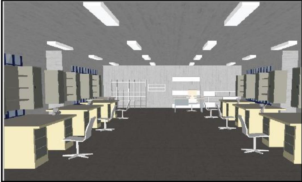
FIGURA N°34: SIMULACIÓN DE LUMINARIAS EXISTENTES 58W
