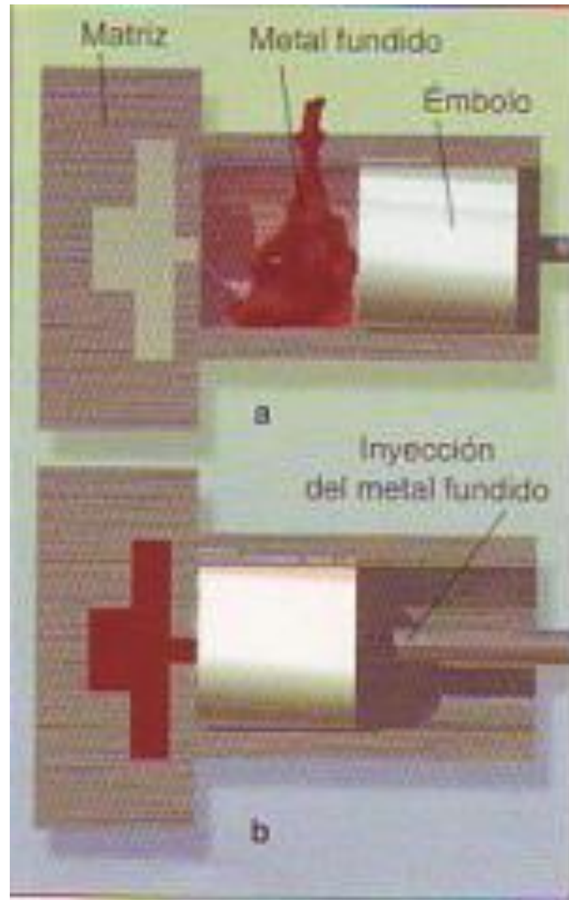
Figura 1. 9. Proceso de fundición por inyección. Fuente: (Pulido, 2009)
