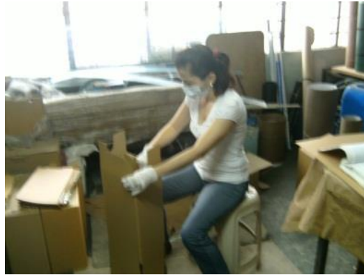
Figura 13. Encolado y armado
