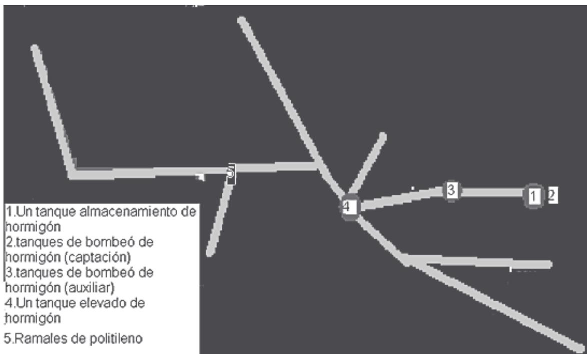
Figura 9. Esquema de la red principal y componentes del sistema
