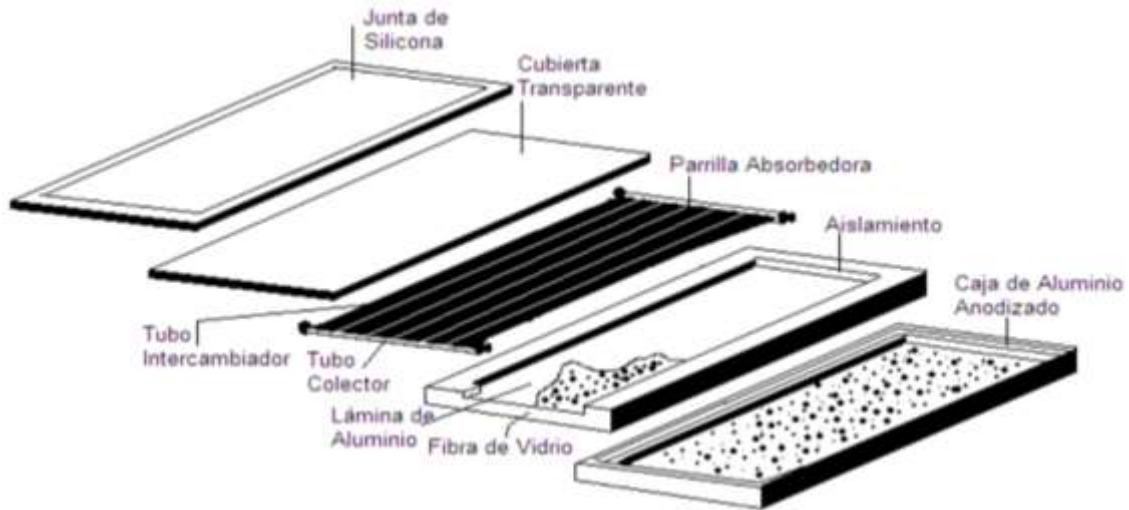
Figura 1.3. Partes fundamentales de un colector solar de placa plana (Fuente: Bértiz L. y M. Álvarez, 2008)
