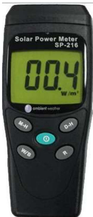
Figura 4.1. Piranómetro SP-216 para medir la radiación solar (fuente: el autor)
