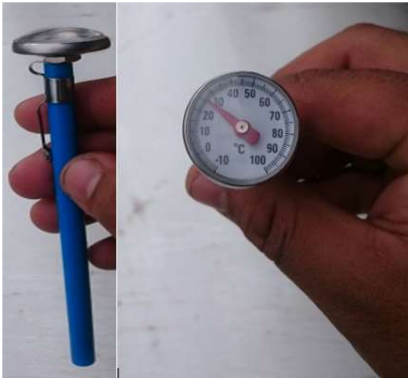
Figura 4.2. Termómetro bimetálico para medir temperatura (fuente: el autor)
