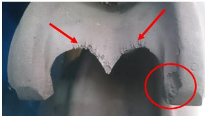
Turbina Pelton central Bell – Kriens 2000 CV / 900 rpm problemas de erosión y desgaste.
