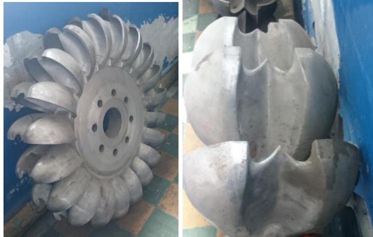
Turbina Pelton central Bell – Kriens 2000 CV / 900 rpm (Manufacturada en China)
