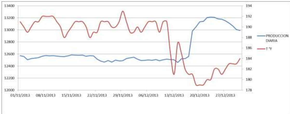
Figura 3. 17 Tendencia de la Producción diaria en relación a la temperatura del agua de inyección en el año 2013.
