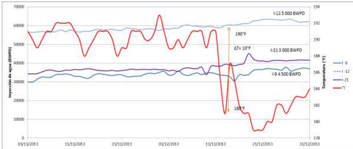
Figura 3. 6 Incremento de la capacidad de Inyección en los pozos de reinyección 2013
