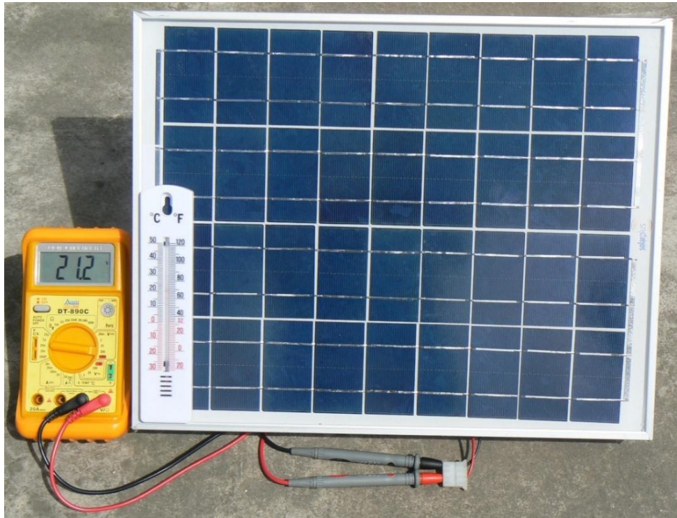
Figura 2.3. Prototipo para mediciones de radiación y orientación fotovoltaica.
