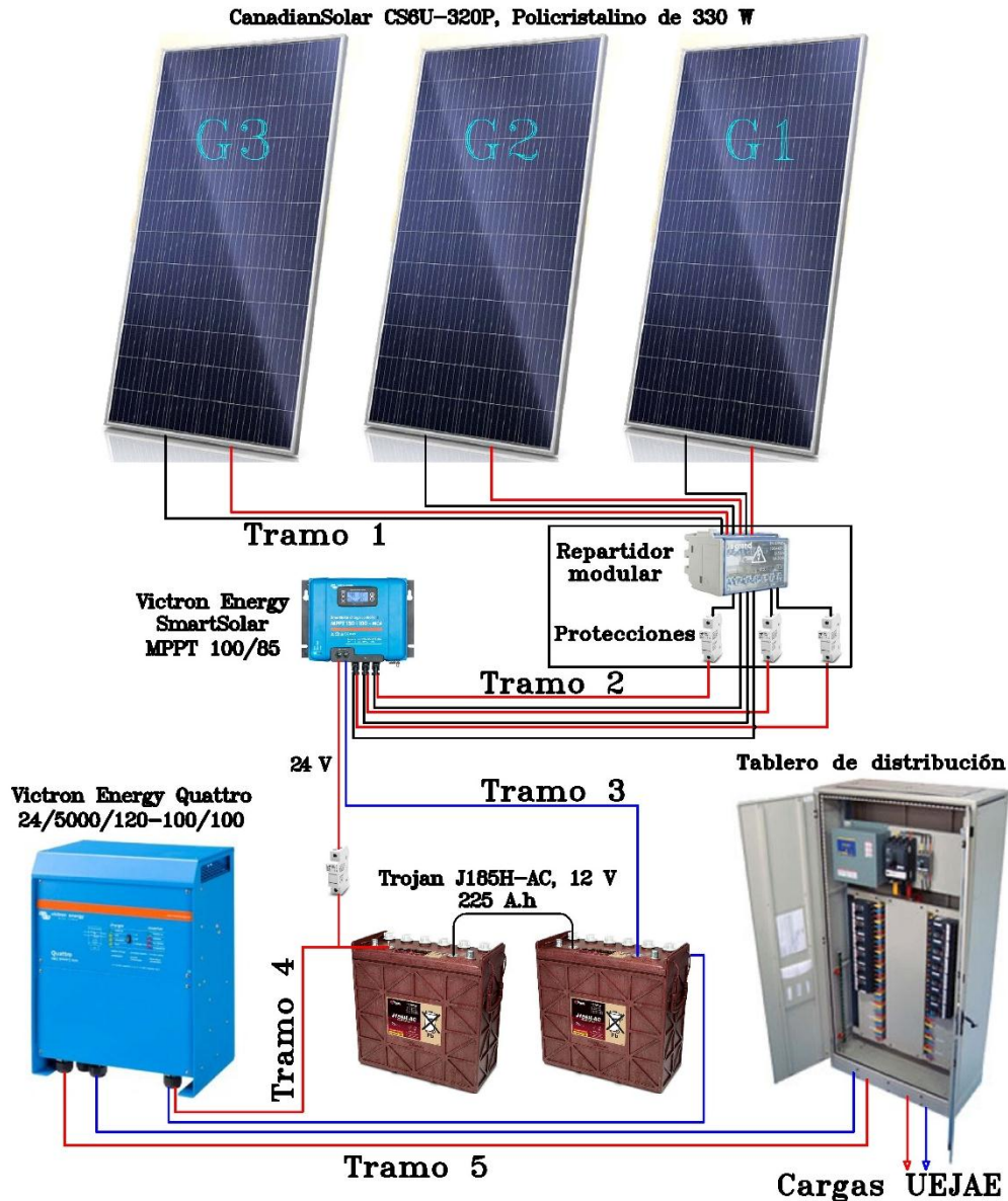
Figura 4.4. Equipos que integran el sistema fotovoltaico autónomo de la unidad educativa “Juan Abel Echeverría”.
