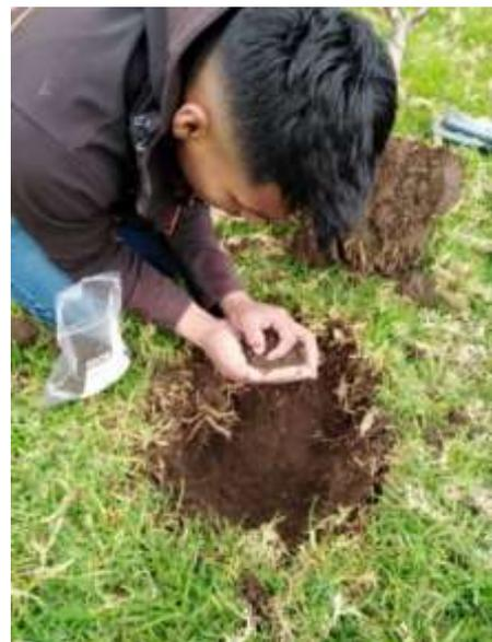
Extracción de impurezas de la muestra.
