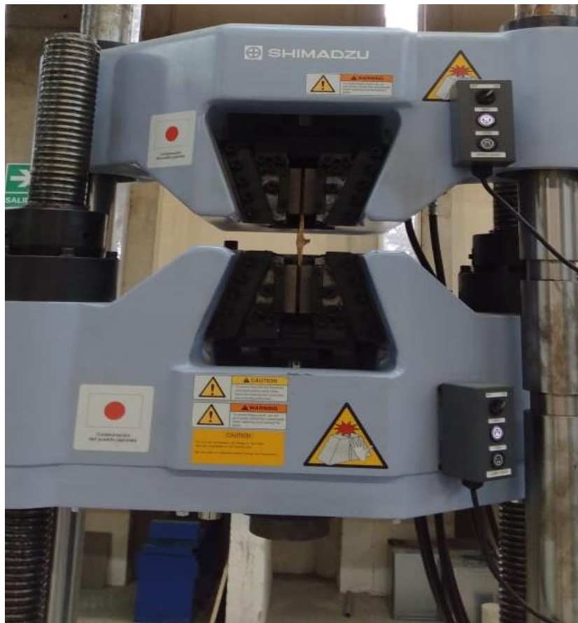
Ilustración 10: Equipo de Ensayo de las probetas de Guadua Angustifolia y Guadua Brava
