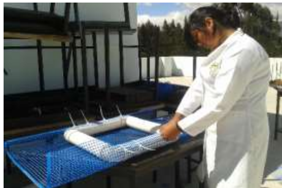
Ilustración9: Ensamblado de la estructura flotante
