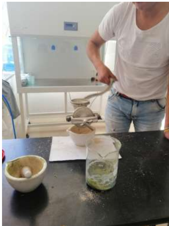
Fotografía 14 Proceso de molienda de la especie Ochroma Pyramidale
