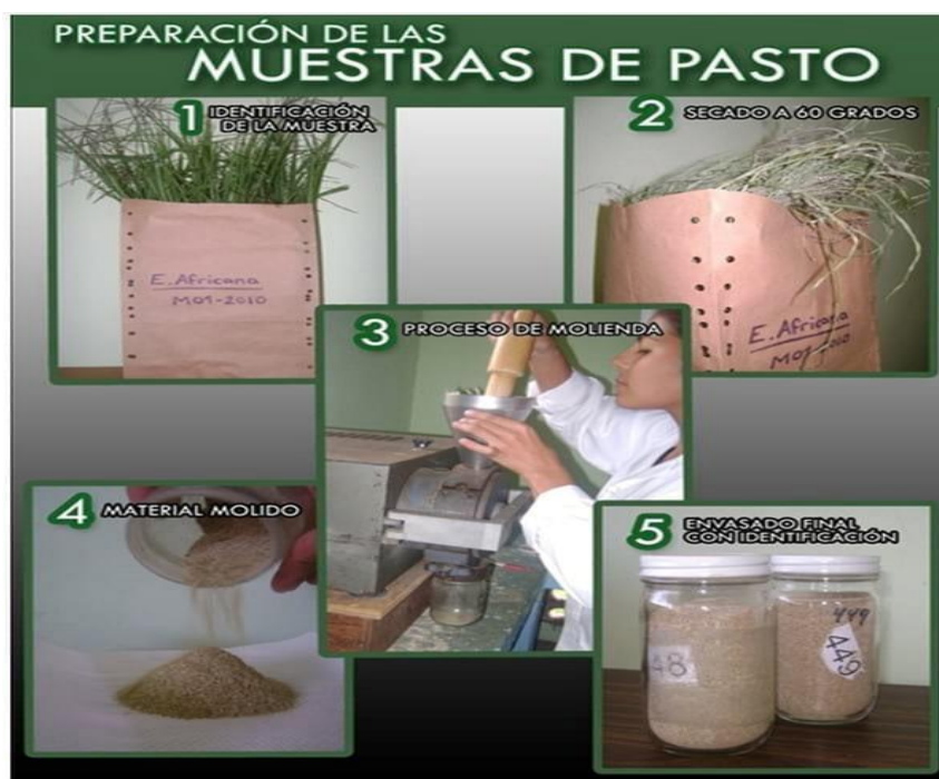
Figura 4 Molienda y rotulación de la muestra
