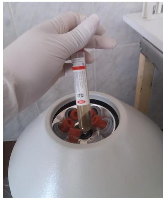
**Ilustración 21:** centrifugación con sulfato de zinc al 33% a 1500 rpm por 1 minuto
