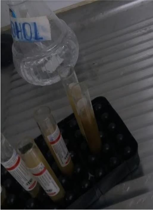
**Ilustración 14:** Colocación de 8ml de muestra en el tubo
