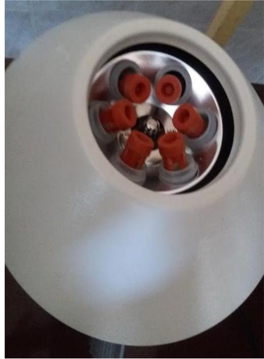
**Ilustración 15:** Centrifugación a 2500 rpm por 2 minutos
