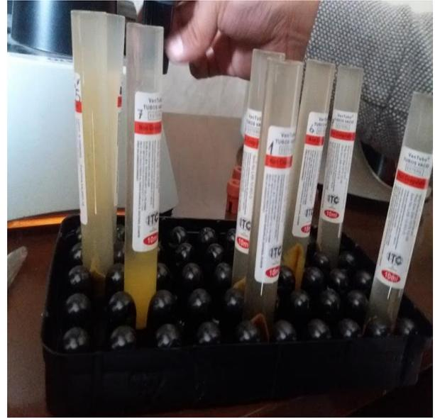
**Ilustración 23:** Colocación de sulfato de zinc al 33% hasta en borde de los tubos
