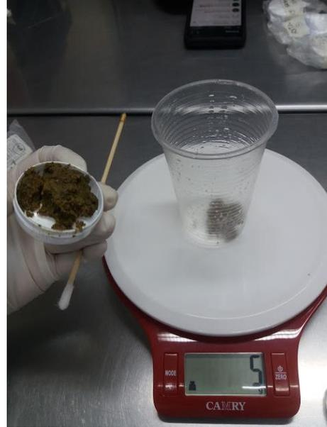
**Ilustración 11:** Aplicación de 3gr de heces
