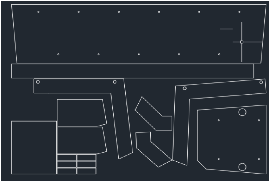
Gráfico 36: Corte de 3485 mm x 2400 mm
