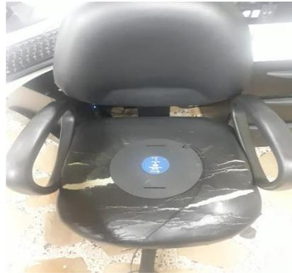
**Medición de vibraciones operador casa de máquinas**
