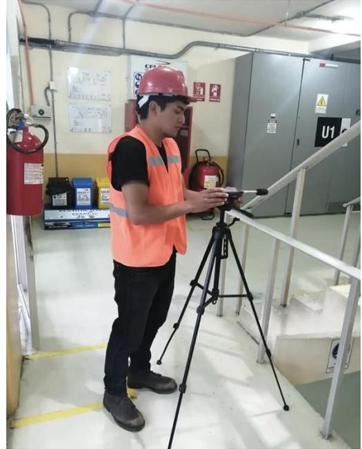
**Medición de ruido operador casa de máquinas.**
