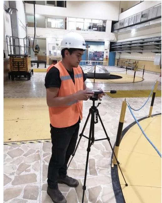
**Anexo 15: Registro fotográfico medición de vibraciones.****Medición de vibraciones operador sala de control**
