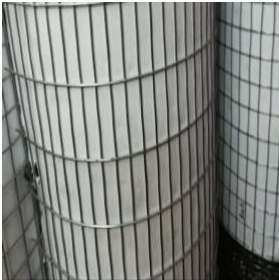
Figura N°24: Malla utilizada para los cajones.
