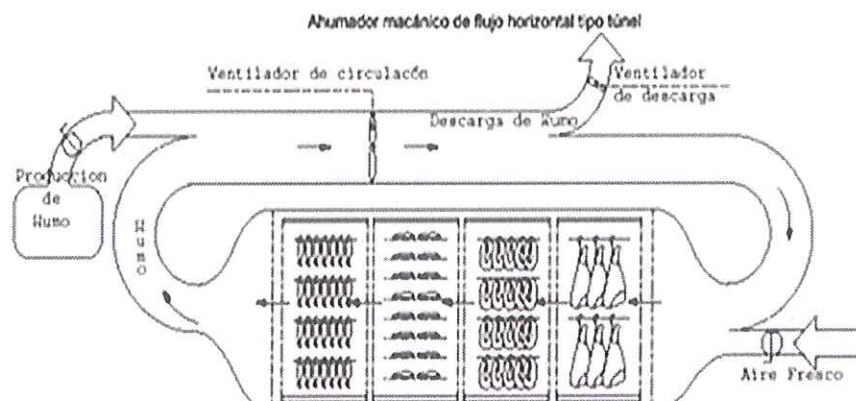
Figura 3.5: Ahumador mecánico de flujo horizontal tipo túnel.
