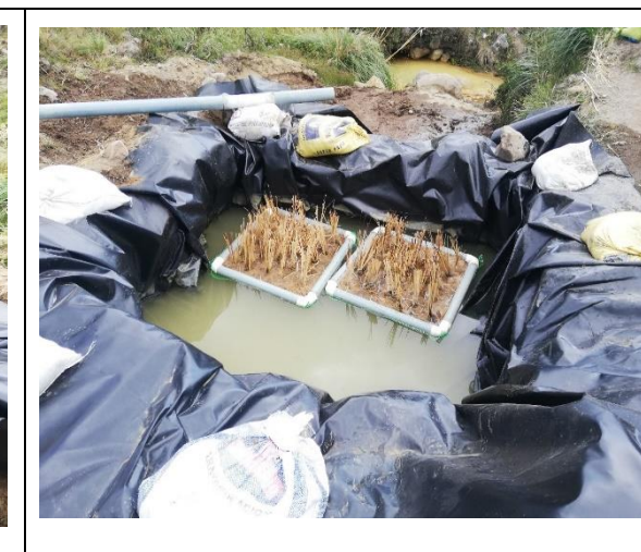
Ilustración 19: Sistema IFA con la especie vetiver
