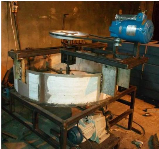
**Figura A15.** Instalación de motores de elevación y de las aspas
