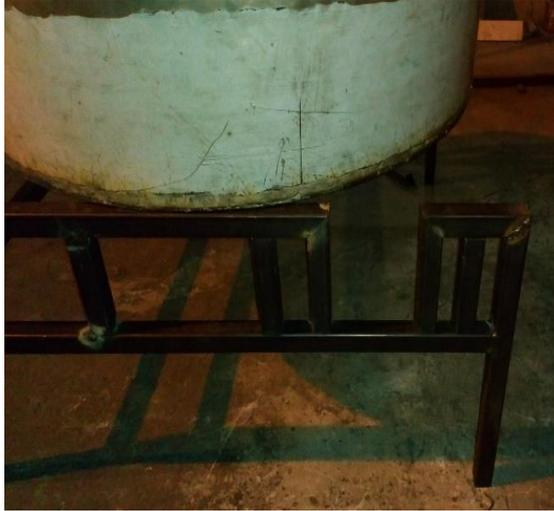
**Figura A5.** Construcción de soporte de la estructura para la inclinación
