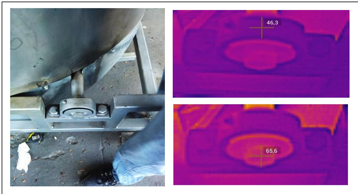
**Figura A39.** Temperatura máxima en el eje 65.6 °C
