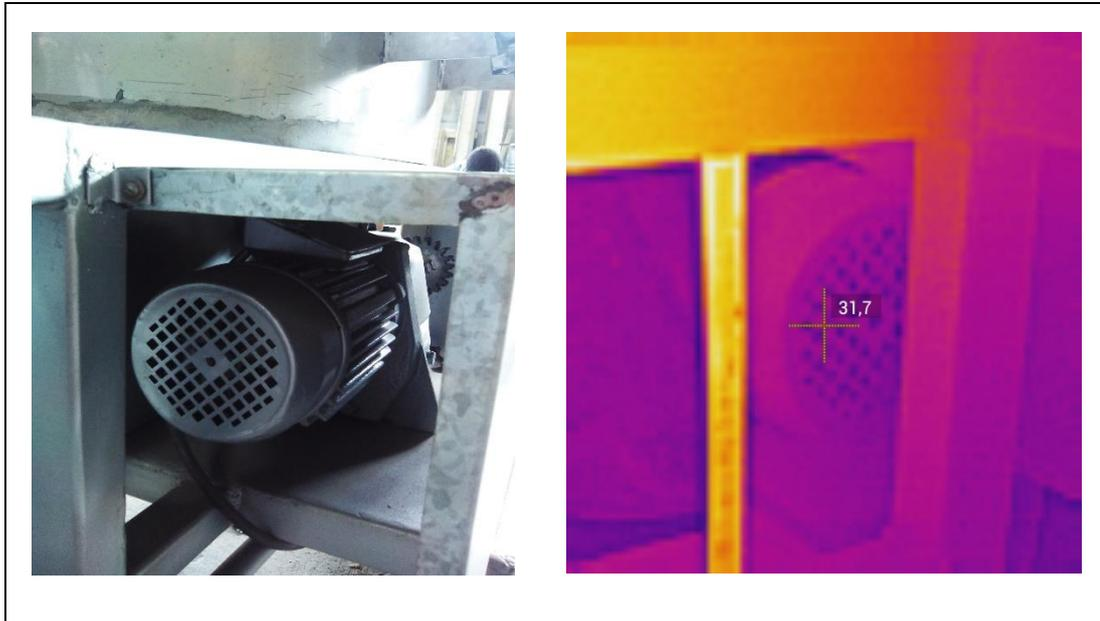
**Figura A41.** Temperatura máxima en el motor de elevación 31.7 °C
