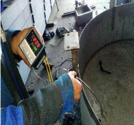
**Figura A21.** Pruebas de temperatura de la cámara de tostado
