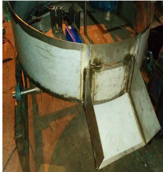
**Figura A12.** Instalación de la puerta de descarga del cereal y la tolva
