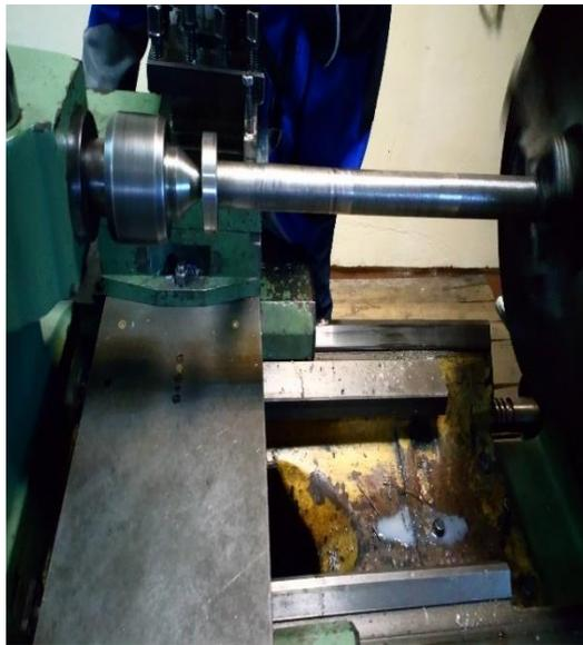
**Figura A11.** Mecanizado del eje de las aspas
