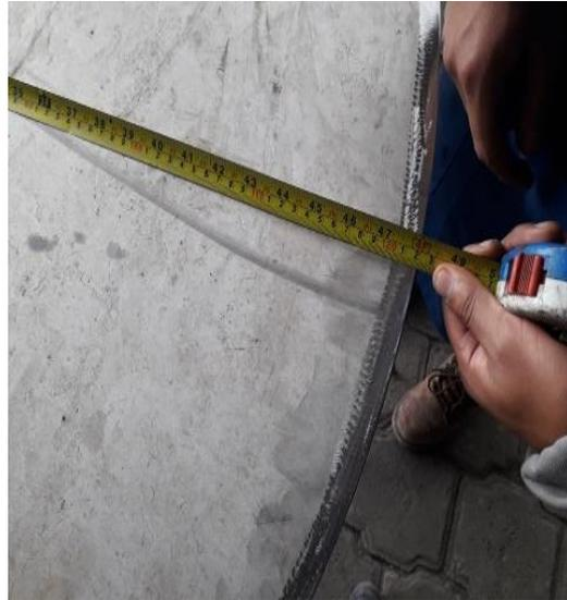
**Figura A1.** Diámetro de la cámara de tostado Acero AISI 304
