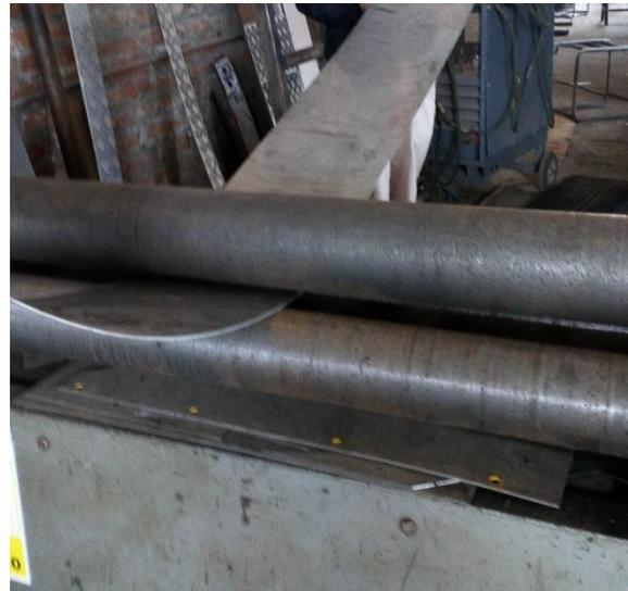
**Figura A2.** Redondeado de la cámara de tostado
