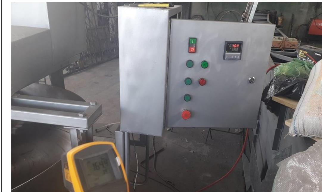
**Figura A42.** Medición de temperatura con el pirómetro nos da una variación de 4 °C con respecto a la cámara de tostado.
