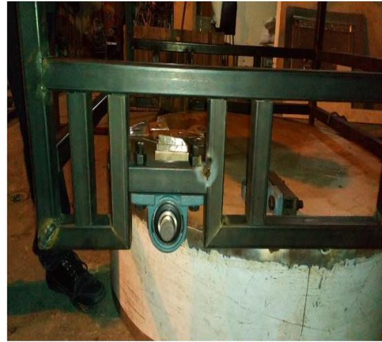
**Figura A8.** Instalación del eje de las chumaceras
