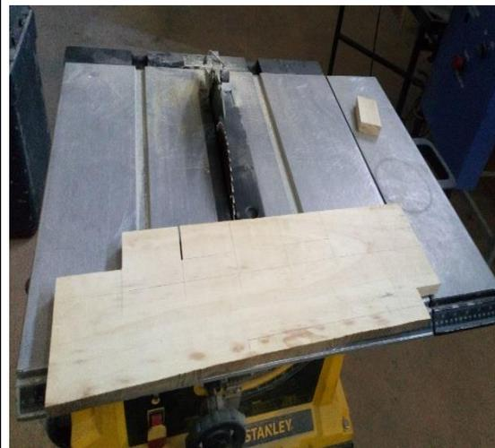
**Figura A24.** Diseño y corte de las aspas de madera
