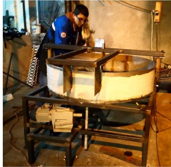
**Figura A10.** Instalación de la estructura de las aspas y la cremallera
