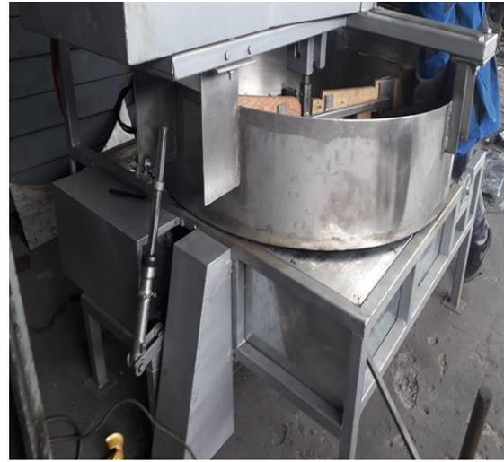
**Figura A26.** Instalación de tapas para la protección de motores
