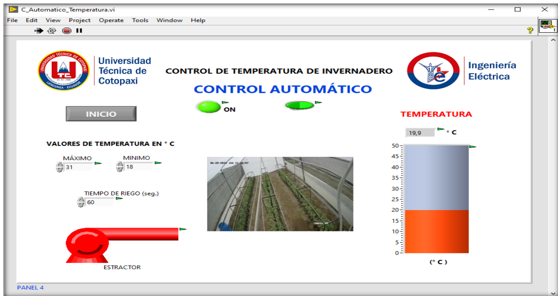
Figura 5. 18 Sub pantalla del control automático de temperatura
