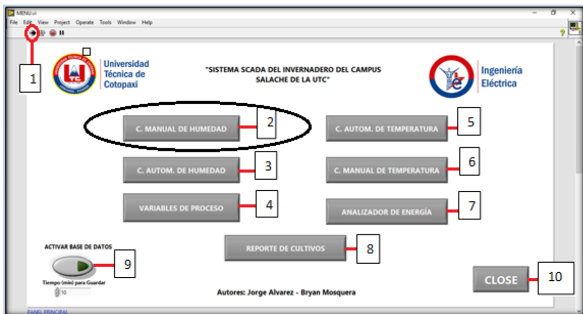
Imagen 5 Pantalla principal seleccionando C. MANUAL DE HUMEDAD
