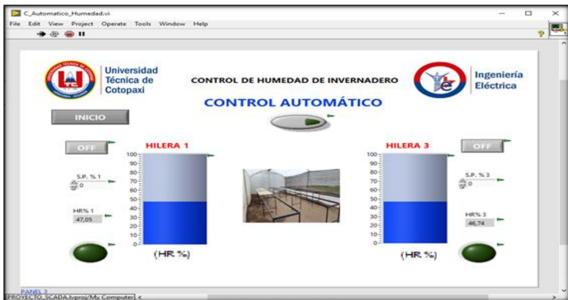
Figura 5. 16 Sub pantalla de control automático de humedad
