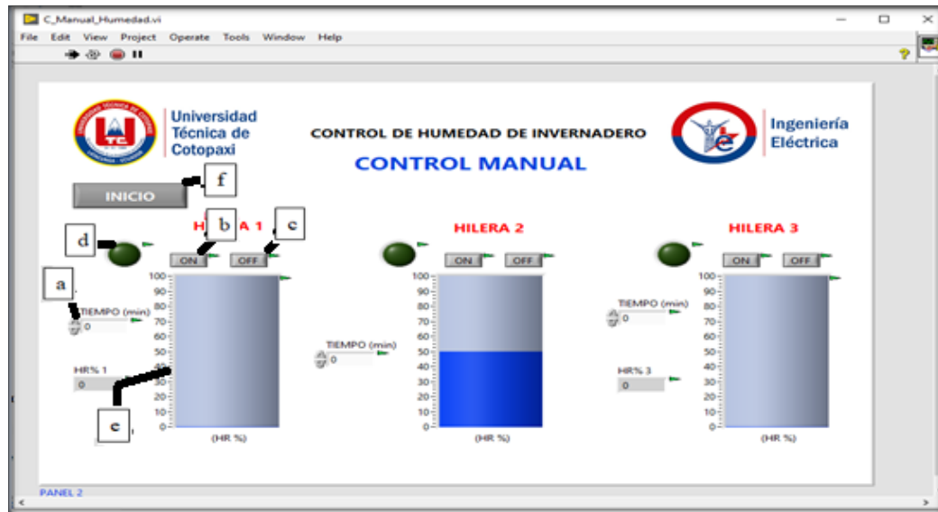
Imagen 6 Pantalla de control manual de humedad
