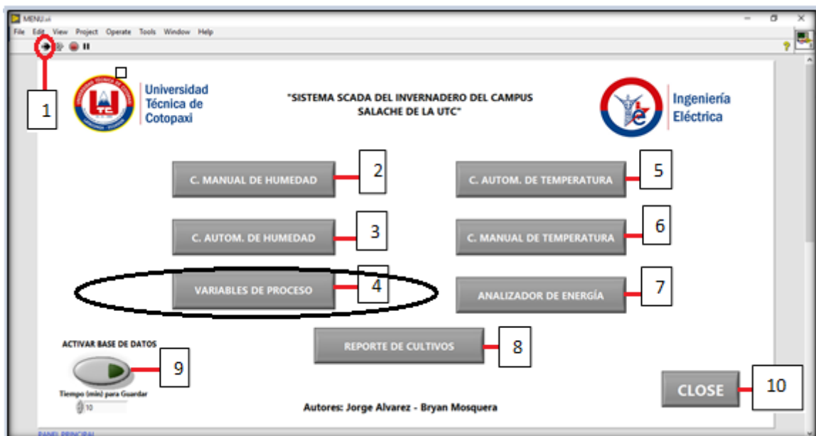
Imagen 13 Pantalla principal seleccionando VARIABLES DE PROCESO
