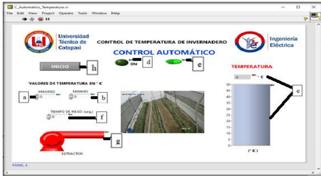
Imagen 10 Pantalla del control automático de temperatura
