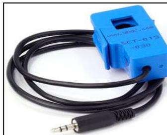
**Figura 5.8.** Sensor de Corriente A.C
