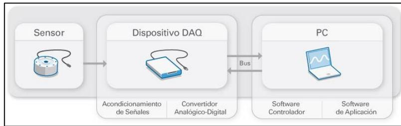
**Figura 3.16.** Partes de un Sistema de adquisición de datos
