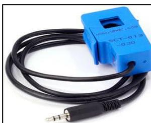
**Figura 12.** Sensor de Corriente A.C
