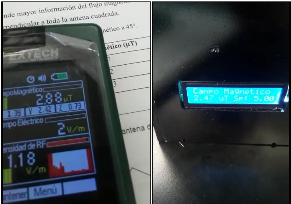
Figura XVII.2: Valores obtenidos en el sensor en 90°, cuando existe fuente de campo magnético
