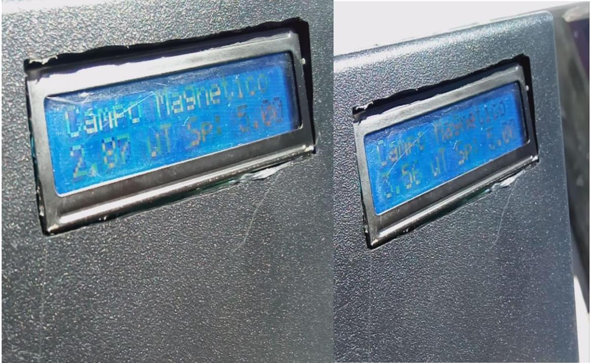
Figura XVIII.1: Valores obtenidos de campo magnético en el prototipo en la subestación Montalvo.
