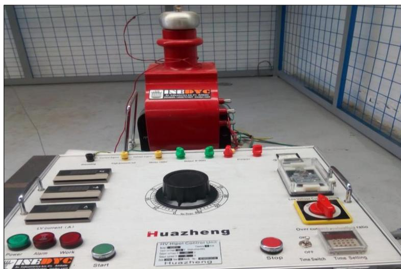
**Figura 4.11:** Transformador de Disrupción y la mochila de control.
