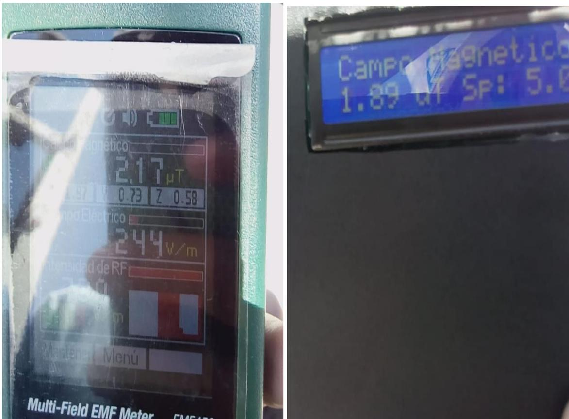
Figura XVIII.2: Valores obtenidos de campo magnético en la subestación Montalvo el sensor patron versus el sensor prototipo.
