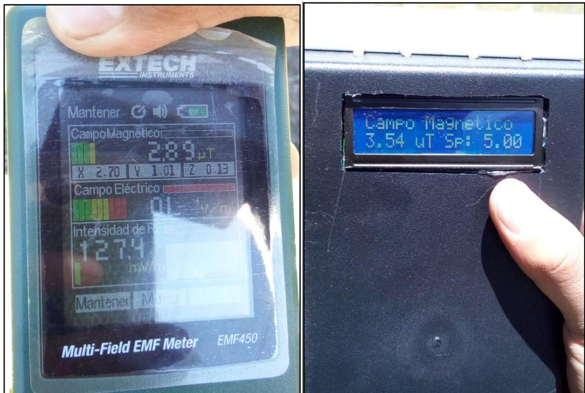
**Figura XVIII.3:** Valores obtenidos de campo magnético entre el sensor patrón y el sensor prototipo.
