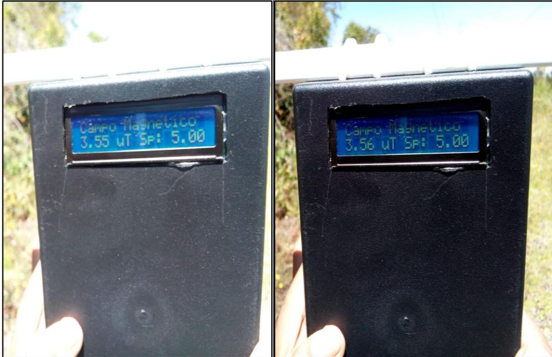
**Figura XVIII.3:** Valores obtenidos de campo magnético en el prototipo en la línea de Transmisión de 230 kV en el cantón Mocha.
