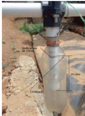
Figura 7. Válvula de alivio.
