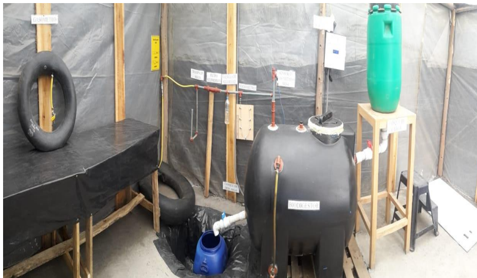
Figura 5.17 Sistema completo de biodigestión implementado. Fuente: [Autor].
