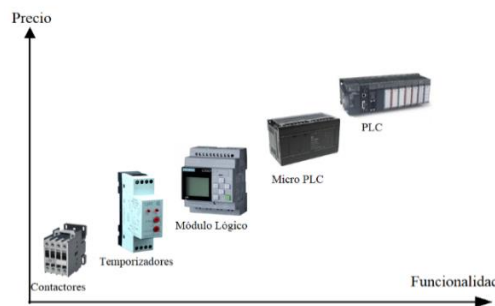
Figura 3.14. Clasificación de PLC's por precio y funcionalidad
