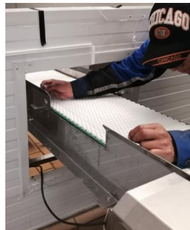
Figura VIII.2. Acople de los laterales a la banda transportadora
