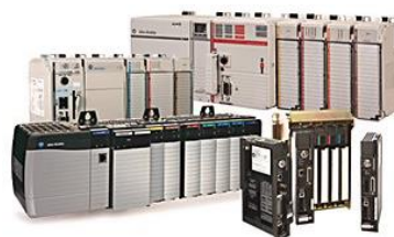
Figura 3.18. PLC Modulares. Fuente: [20].
