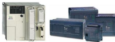
Figura 3.17 . PLC Compacto Micro. Fuente: [20].
