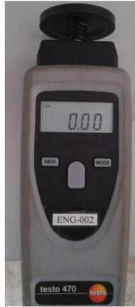
**Figura 3.10** Medidor del número de revoluciones Testo 470
