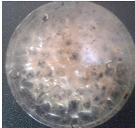
**Figura 3.1 Montaje de muestras en resina para ataque en frío con pulido de 0.05 um**
