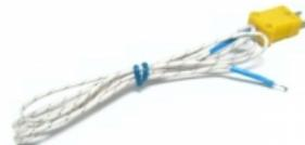
**Figura 3.9 Termopar tipo K**
