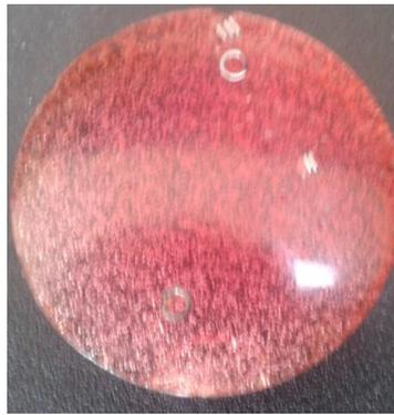
**Figura 3.3 Montaje de muestras para en bakelita para ataque en caliente con pulido de 0.05 um**
