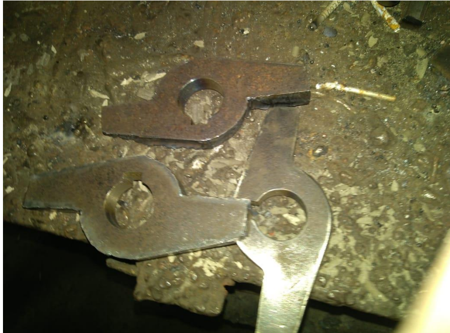
Anexo 7 Corte finalizado de las cuchillas.
