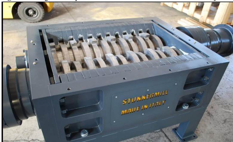
Figura 7. Diagrama esquemático de la trituradora cortante de dos ejes
