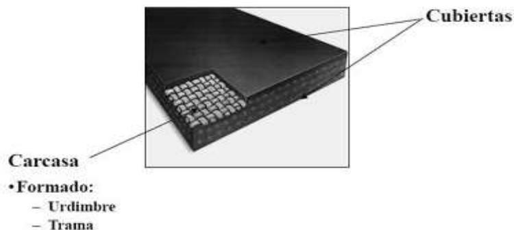
**Figura 1.14.** Carcasa y recubrimiento de la banda. Adaptado de Heras (2014).
