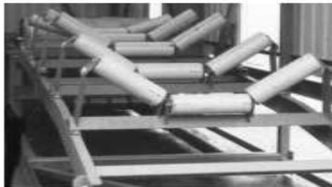
**Figura 1.7.** Bastidor formado por dos largueros. Adaptado de Ray (2008).
