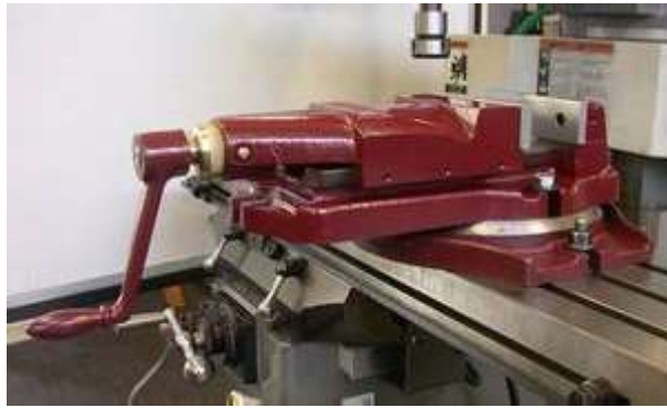
Figura 1.9. Mordaza de sujeción de las piezas (Xin et al. , 2014).
