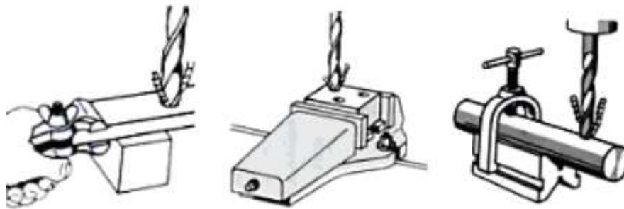
Figura 1.10. Formas de sujeción de las piezas en la mesa (Lingaiah, 2004).
