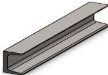
Figura. 3.7. Modelo en 3D del perfil tipo C de la estructura de la taladradora vertical.
