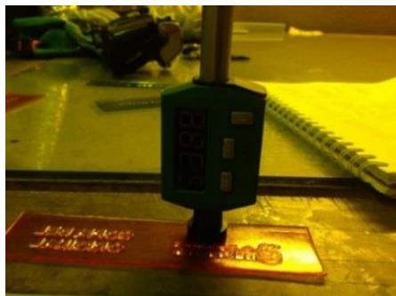
Figura 3.8 Medición de dureza después del secado
