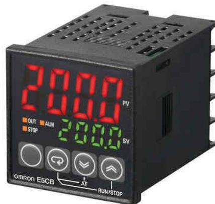
Figura 2.6. Controlador de temperatura
