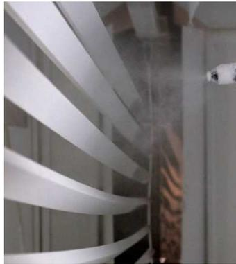
Figura 9. Perfiles en el horno de pintura
