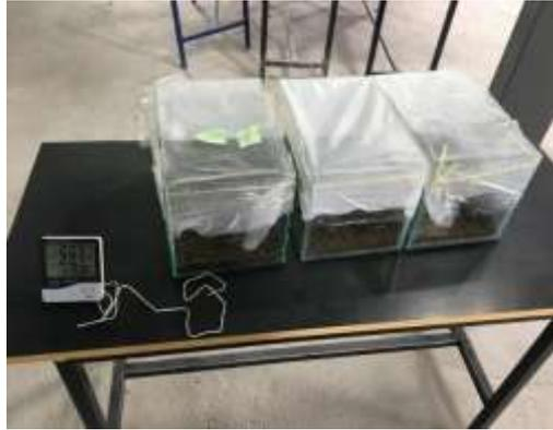
Figura 19. Acondicionamiento de la temperatura a 20°C, con el uso de un calefactor directamente sobre la cámara de crianza inoculación laboratorio de entomología Carrera de Ingeniería Agronómica (Foto: L. Reimundo, 2019)
