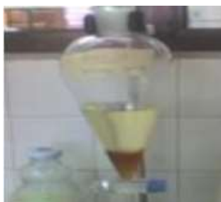
Fig. 4 Biodiesel y glicerina obtenida de la grasa de pollo
