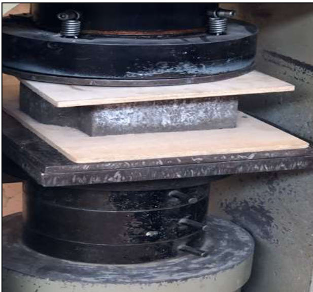
Figura 3 : Pruebas de ensayos de adoquines . Fuente: Laboratorio de suelos.
