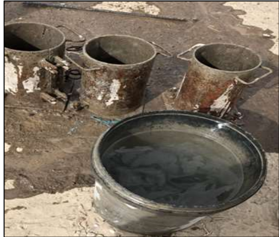
Figura 6: Cilindros lavados. Fuente: Constructora Gutiérrez.
