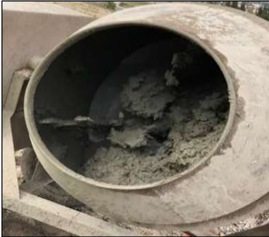
Figura 5: Concretera con mezcla. Fuente: Constructora Gutiérrez.
