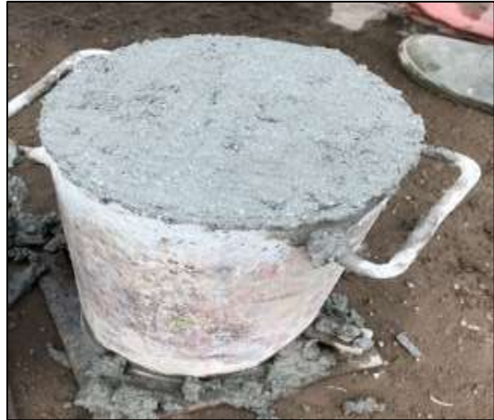
Figura 10: Cilindro con Concreto. Fuente: Constructora Gutiérrez.
