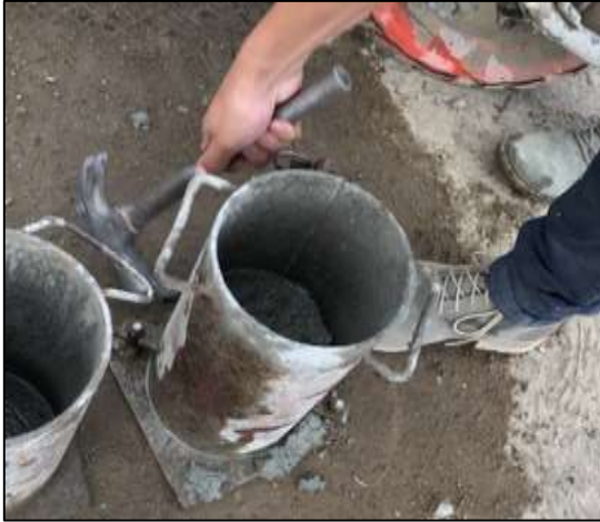
Figura 9: Golpe con martillo al cilindro. Fuente: Constructora Gutiérrez.
