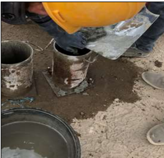
Figura 7: Concreto en cilindros. Fuente: Costructora Gutiérrez.
