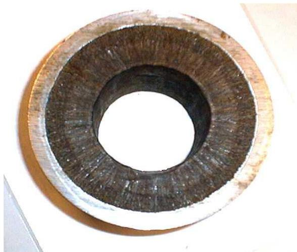
**Figura 6: Tubería taponada por escala.**
