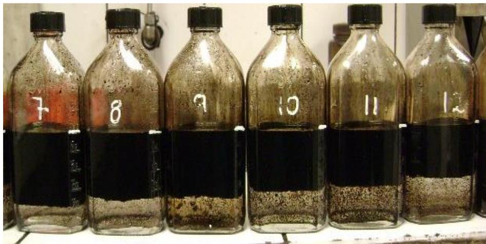
**Figura 3: Evaluación en prueba de botella, después de la acción del químico demulsificante.**
