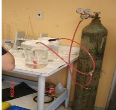
**Figura 30: Saturación de la solución salina con  $\text{CO}_2$ .**
