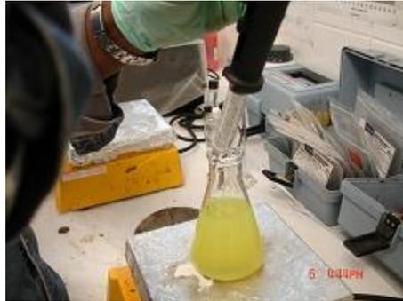
**Figura 43: Determinación de la dureza.**
