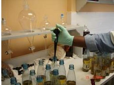
**Figura 34: Dosificación de las botellas de prueba.**
