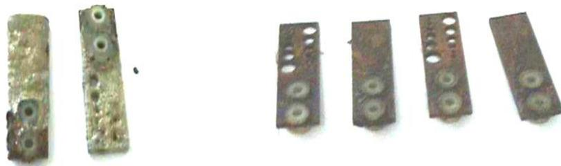
**Figura 7: Cupones instalados en el pozo Lago 33.**
