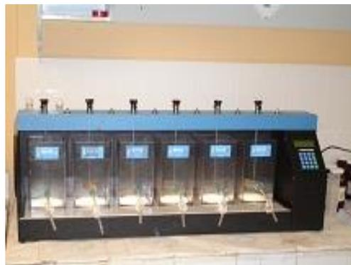
**Figura 59: Equipo de prueba de jarras a utilizar.**
