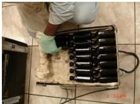
**Figura 23: Agitador de las botellas de prueba.**
