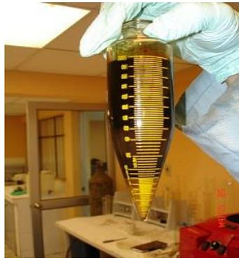
**Figura 20: BSW del composite de prueba.**
