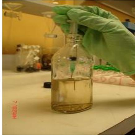
**Figura 52: Muestreo de la botella de prueba.**
