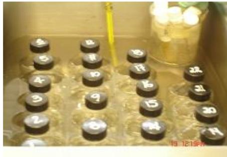
**Figura 41: Botellas de prueba colocadas en baño térmico.**
