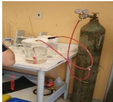
Figura 40: Saturación de las soluciones sintéticas con CO<sub>2</sub>.
