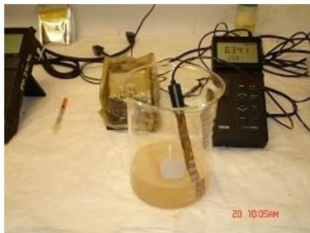
**Figura 62: Medición del pH del agua de prueba.**
