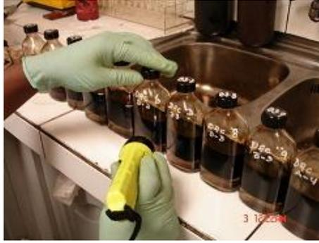
**Figura 26: Lectura de la calidad del agua y la interface en las botellas.**
