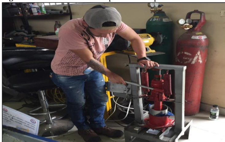
Figura 12: Extracción de aceite por medio de prensa hidráulica manual.
