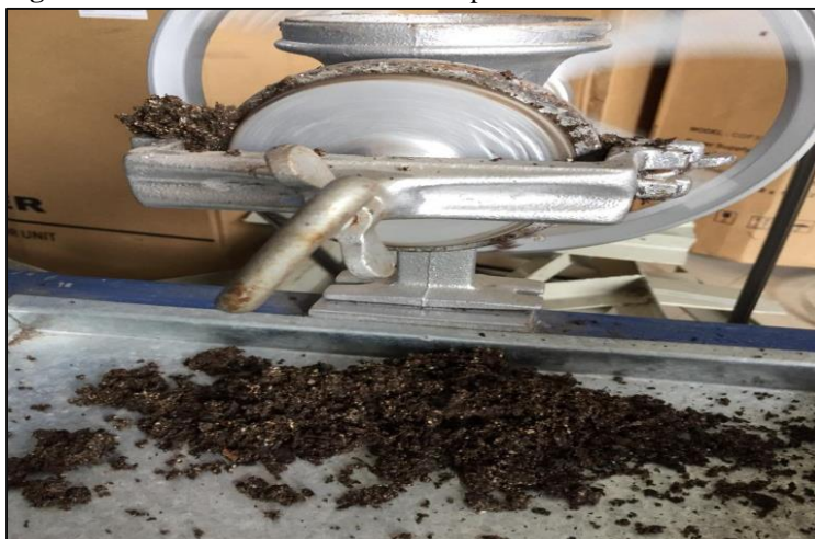
Figura 11: Trituración de la semilla de piñón.
