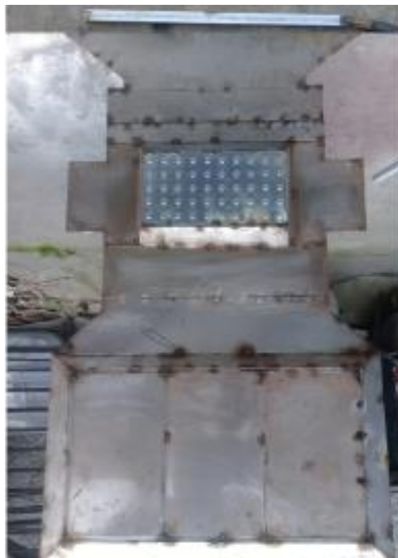
Anexo 5 Construcción mediante suelda eléctrica y láminas de tol
