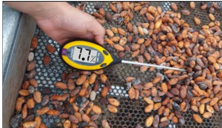
Fotografía 7: Medida de humedad de grano seco. Fuente: Cuasquer C., Villegas J.
