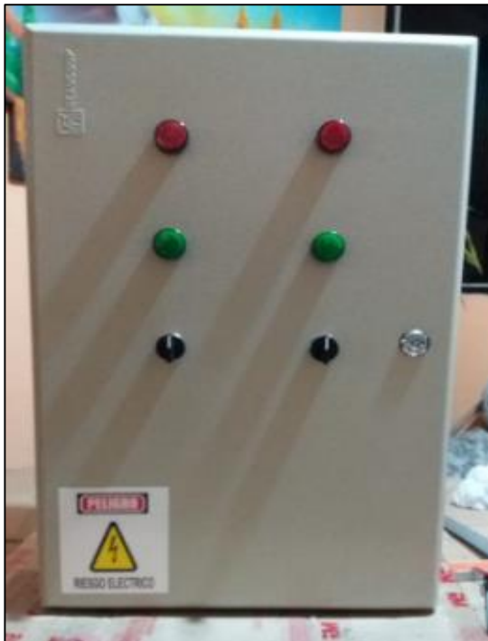
Fotografía 18: Implementación de luces piloto y selector de tres posiciones. Fuente: Cuasquer C., Villegas J.
