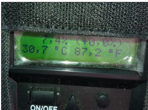
Fotografía 34: Medida de prueba 1 de humedad del grano seco. Fuente: Cuasquer C., Villegas J.
