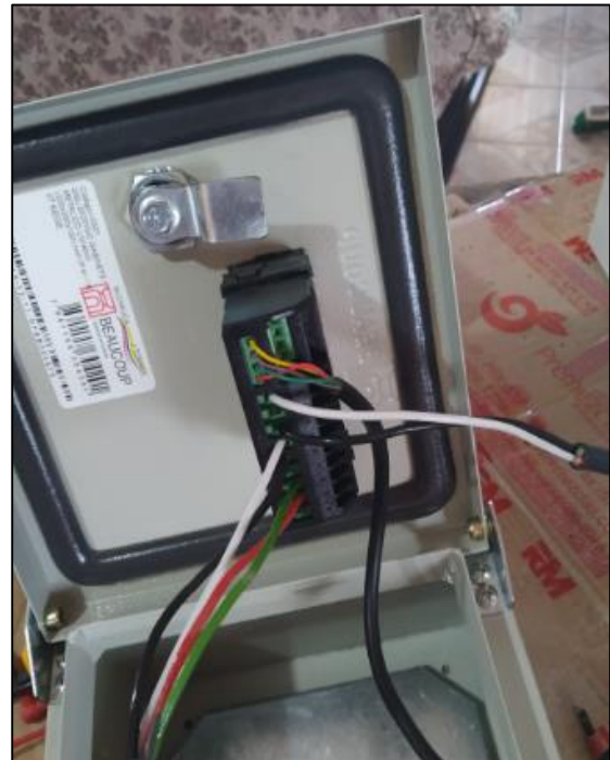
Fotografía 25: Conexión de sensor de temperatura y humedad. Fuente: Cuasquer C., Villegas J.
