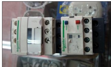
Fotografía 4: Relé térmico. Fuente: Cuasquer C., Villegas J.
