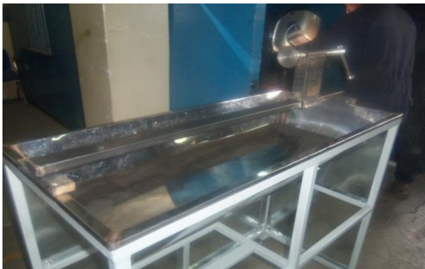
Ubicación de la bandeja y el cabezal móvil a la estructura principal del banco
