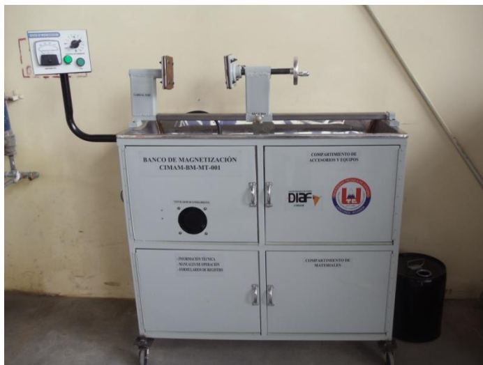
Banco de magnetización con sus respectivos componentes y señalización
